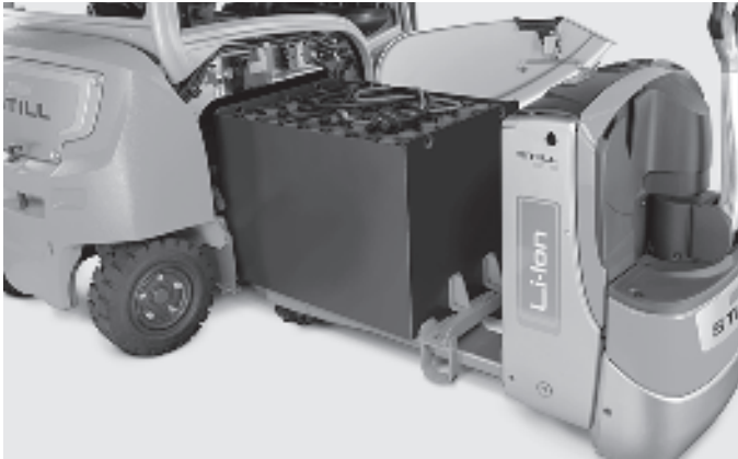
Sostituzione della batteria con transpallet elettrico
