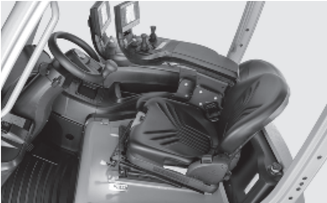
Sedile orientabile per una retromarcia confortevole
