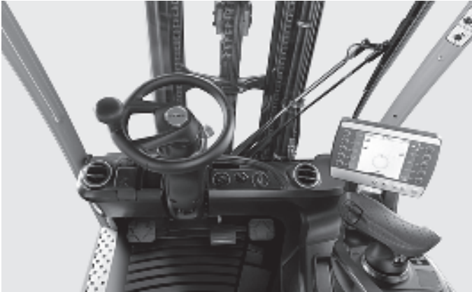
Postazione di lavoro con display e unità di comando, Joystick 4Plus e riscaldamento
